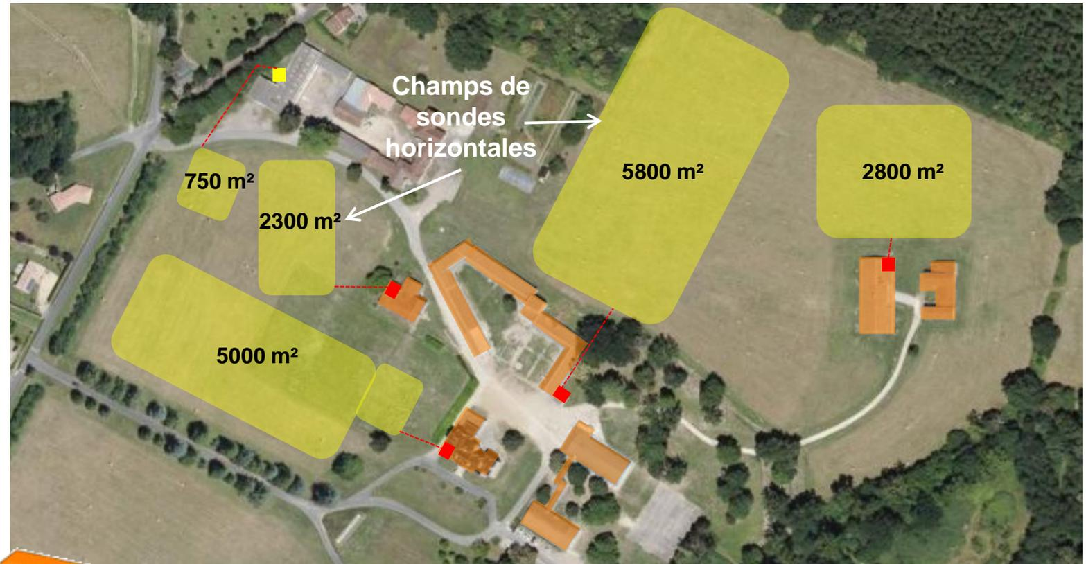
En remplacement des chaufferies fioul : 4 Champs de sondes horizontales (15 900 m<sup>2</sup>) et 4 pompes à chaleur (450 kW)
